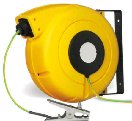
Réf. 18-32000-120 / Enrouleur série CRXK Câble 1x10mm 2 HO7V-K PVC - Longueur 20m + pince Marquage selon la Directive CE94/9/CE II 2G / II2D Certificat d'examen CE de type BVS 10 ATEX E 84
