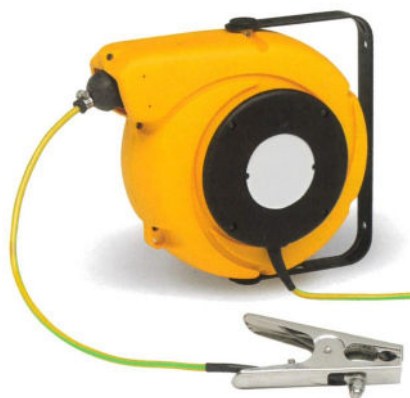
Réf. 18-32000-110 / Enrouleur série CR7K Câble 1x10mm 2 HO7V-K PVC - Longueur 10m + pince Marquage selon la Directive CE94/9/CE II 2G / II2D Certificat d'examen CE de type BVS 10 ATEX E 84
